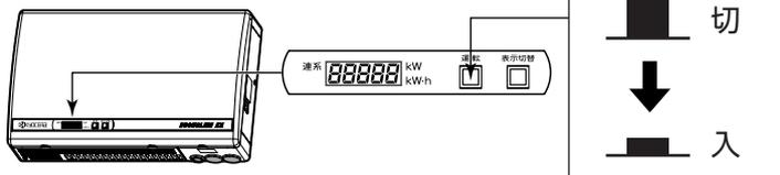
連系運転から自立運転に切り替えたとき、数秒～1分程度たった後に発電を開始します。その間、表示部は“—”を点滅表示し、自立運転待機中であることを示します。
