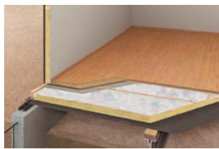
断熱性能を高めた構造躯体の断面イメージ
