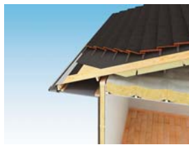
断熱性能を高めた構造躯体の断面イメージ
