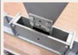
制震ダンパー内の高減衰ゴム
