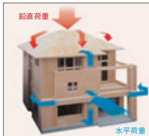
外力を分散して受け止める「モノコック構造」
