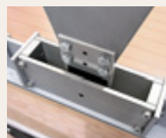
制震ダンパー内の高減衰ゴム
