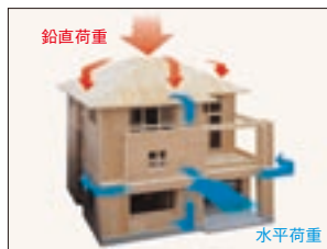
外力を分散して受け止める「モノコック構造」
