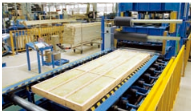
木質パネルへの断熱材充填
