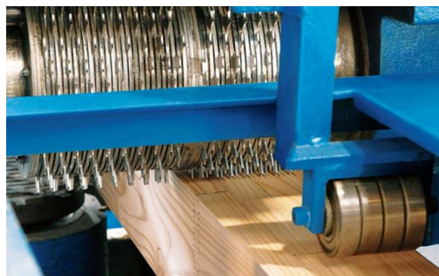
土台・半土台は独自のインサイジング加工で防腐処理を実施
