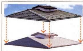
屋根の「かぶせ工法」
