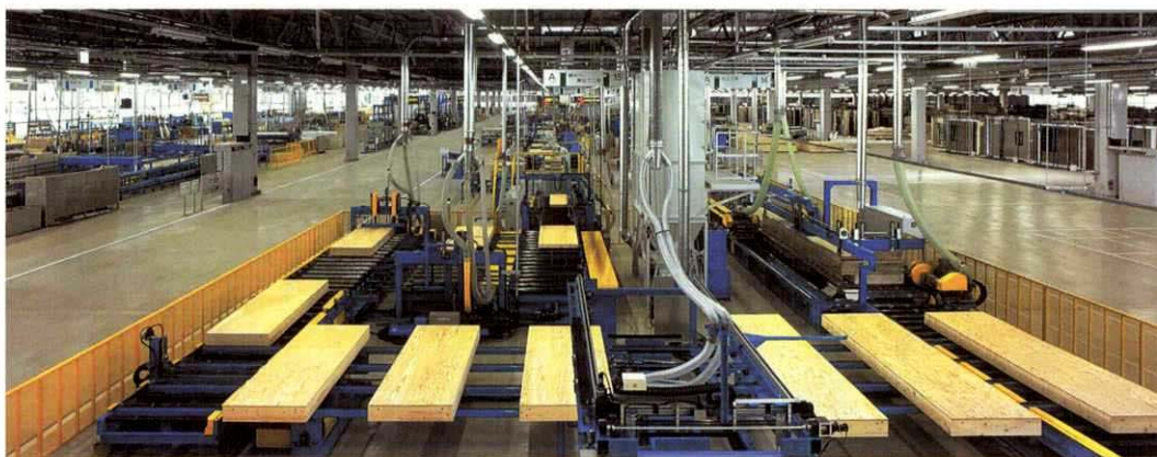
工場のパネル生産ライン
