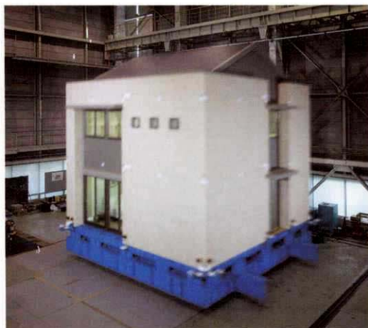
次世代耐震構造「MGEO」の実大振動実験
