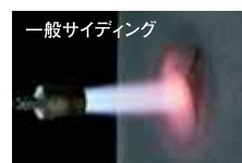
外壁の加熱比較実験(開始3分後)
