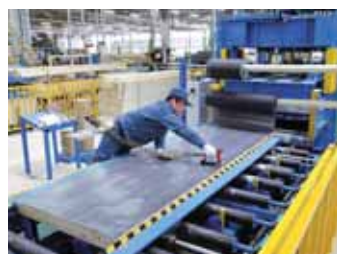
床パネルの防蟻シート取り付け
