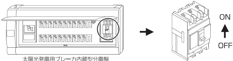
※分電盤、太陽光発電用ブレーカの形状が異なる場合があります。また、太陽光発電用ブレーカは、分電盤とは別に設置される場合もありますので、必ず設置場所を施工業者にご確認ください。
