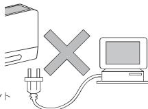
■自立運転出力用コンセントおよび本体より別途配線した自立運転専用コンセントは、商用コンセントへの接続は絶対に行わない
