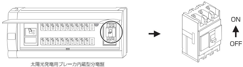
※分電盤、太陽光発電用ブレーカの形状が異なる場合があります。また、太陽光発電用ブレーカは、分電盤とは別に設置される場合もありますので、必ず設置場所を施工業者にご確認ください。
