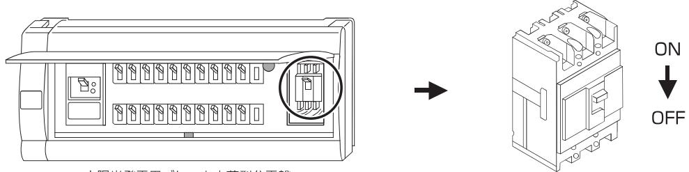
※分電盤、太陽光発電用ブレーカの形状が異なる場合があります。また、太陽光発電用ブレーカは、分電盤とは別に設置される場合もありますので、必ず設置場所を施工業者にご確認ください。
