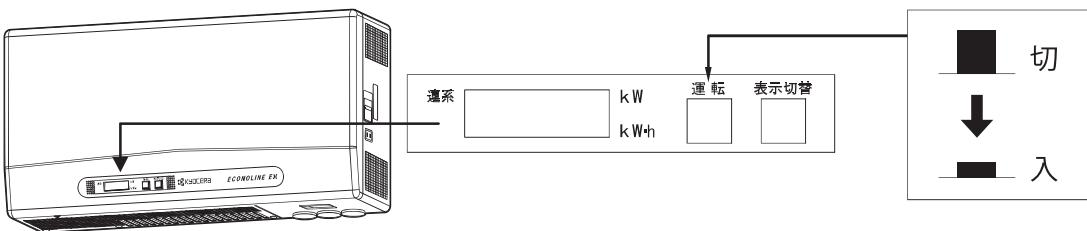
運転スイッチを「入」にして数分後、連系表示ランプが点灯して、発電を開始します。
