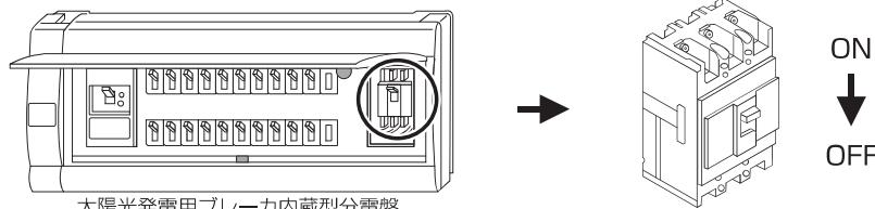
※分電盤、太陽光発電用ブレーカの形状が異なる場合があります。また、太陽光発電用ブレーカは、分電盤とは別に設置される場合もありますので、必ず設置場所を施工業者にご確認ください。
