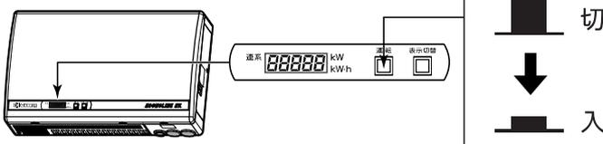
連系運転から自立運転に切り替えたとき、数秒～1分程度たった後に発電を開始します。その間、表示部は“—”を点滅表示し、自立運転待機中であることを示します。
